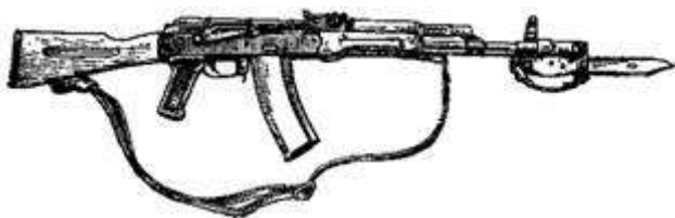
Общий вид 5,45-мм автомата Калашникова
