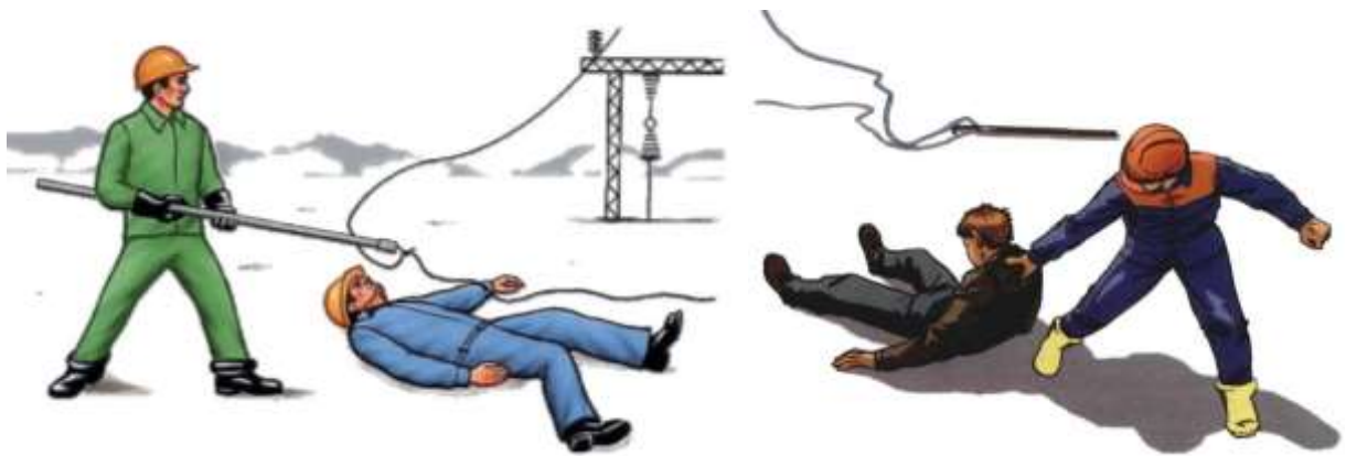
Рис. 3. Способы освобождения пострадавшего при напряжении выше 1000 В
