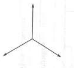
Рис. 6.1. Векторная диаграмма напряжений и токов трехфазной ЭЦ с равномерной нагрузкой однофазных приемников, соединенных «звездой» (строится при подготовке к работе).
