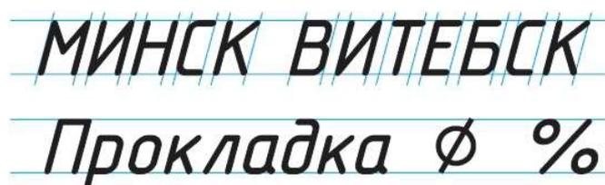
Рисунок 15. Начертание букв чертежного шрифта
