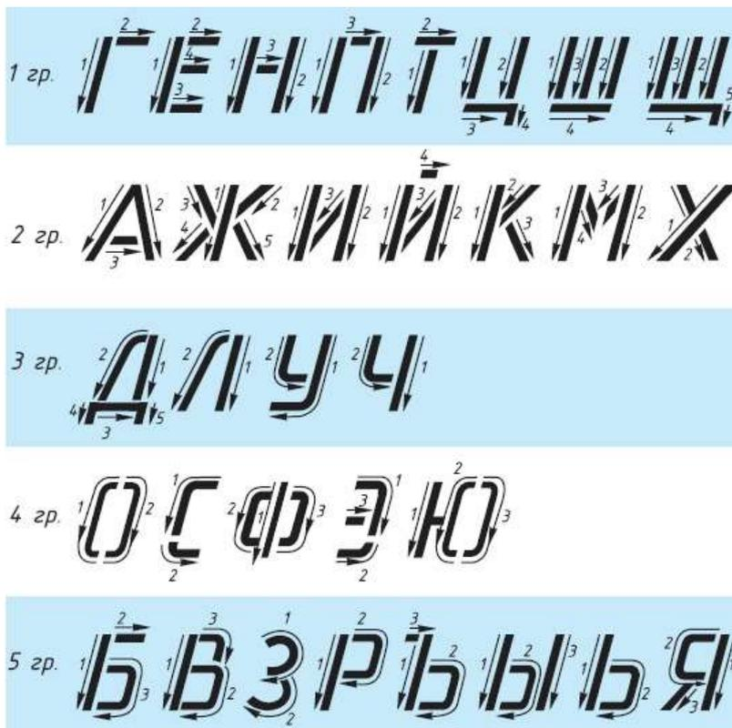
Рисунок 13. Начертание букв чертежного шрифта
