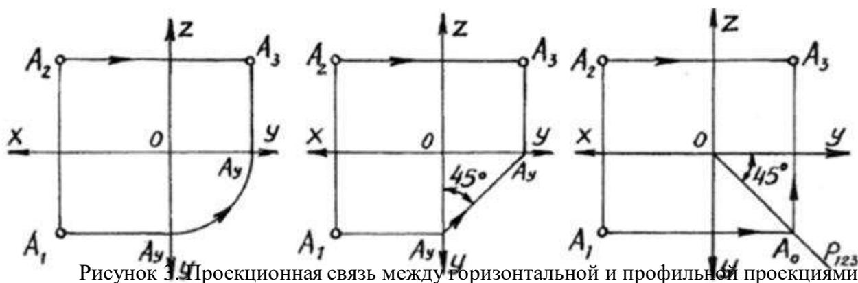
Рисунок 3.4. Проекционная связь между горизонтальной и профильной проекциями
